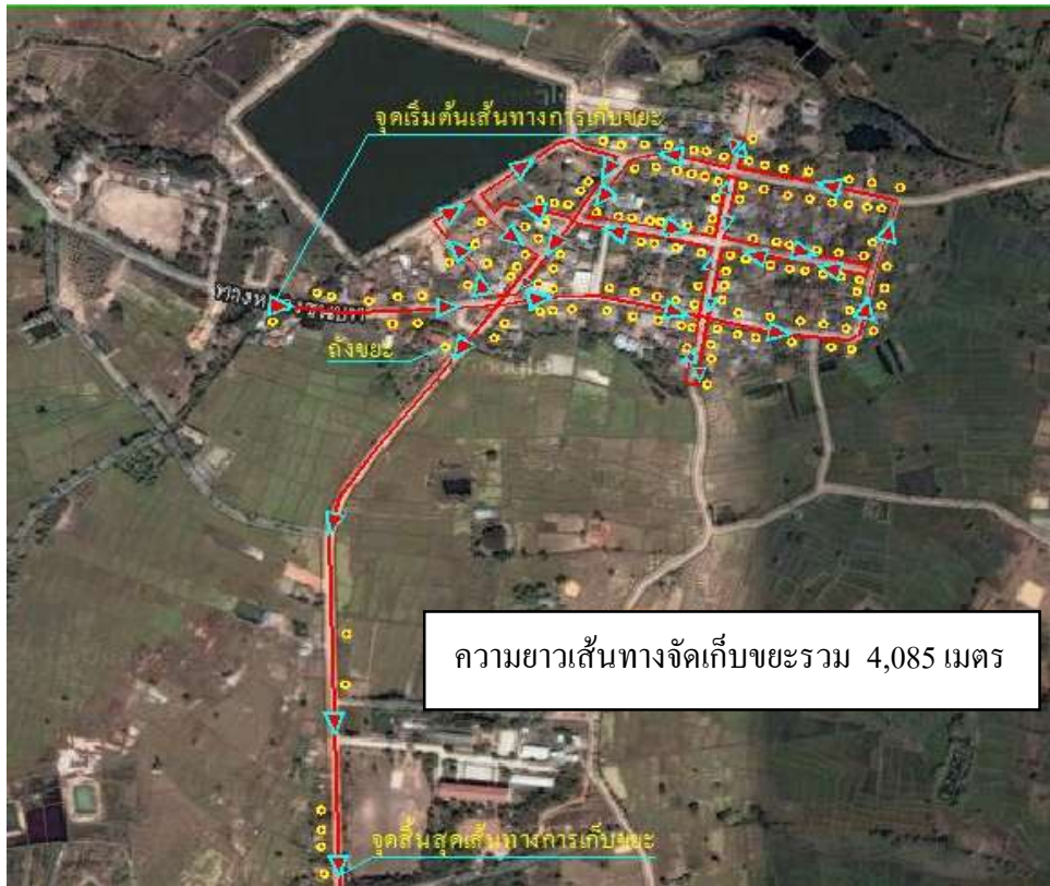
รูปที่ 3.10 แผนผังการใช้เส้นทางในการจัดเก็บขยะแบบดั้งเดิมของบ้านดงเต็ง หมู่ที่ 5
